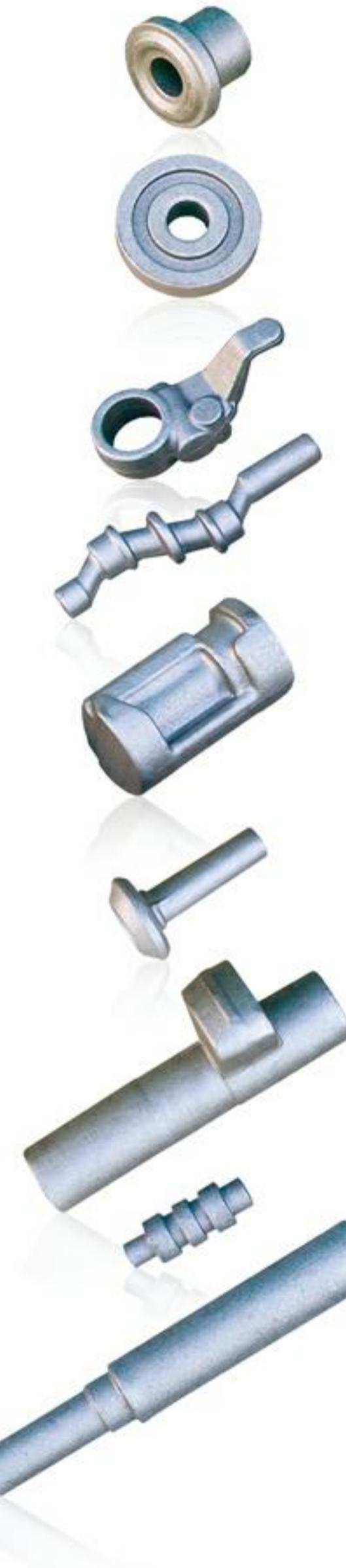
Проектная мощность кузнечного производства составляет 24,5 тыс. тонн поковок в год. Производство позволяет обеспечивать выпуск поковок весом от 40 г до 11 кг. В настоящее время в кузнечном производстве действовано следующее технологическое оборудование:
